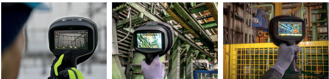
Die Si2-Kamera von FLIR erkennt, bewertet und misst elektrische Defekte, mechanische Probleme sowie Luft- und Gasleckagen.
